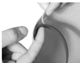
Installation der Dichtung
